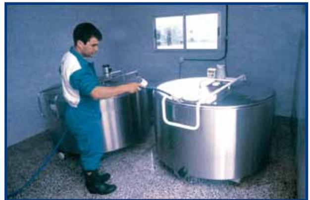
Operario limpiando exteriormente un tanque de refrigeración, concretamente aclarando tras la limpieza exterior.
