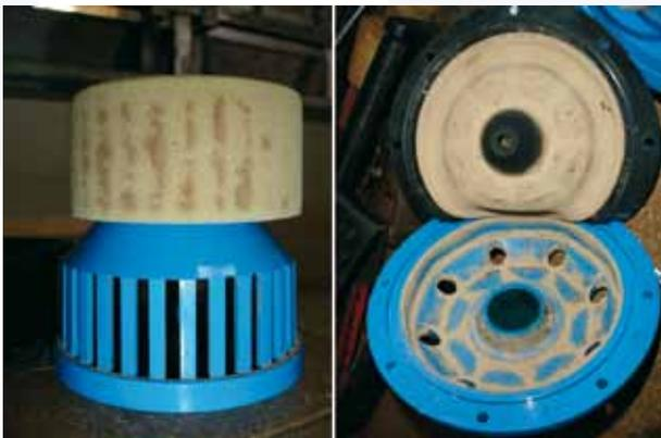
Detalle del filtro de aire de un regulador, antes de ser limpiado. Se puede observar que tiene gran cantidad de polvo, lo que puede provocar un funcionamiento incorrecto.
